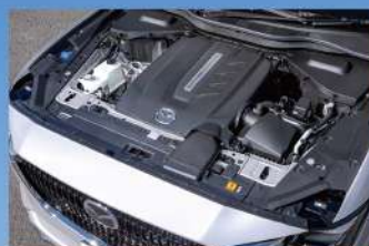
↑188PSの2.5ℓガソリンエンジンに129kW(175PS)の高出力モーターを組み合わせる。PHEVはFRを基本にした4WDモデルとなる。
